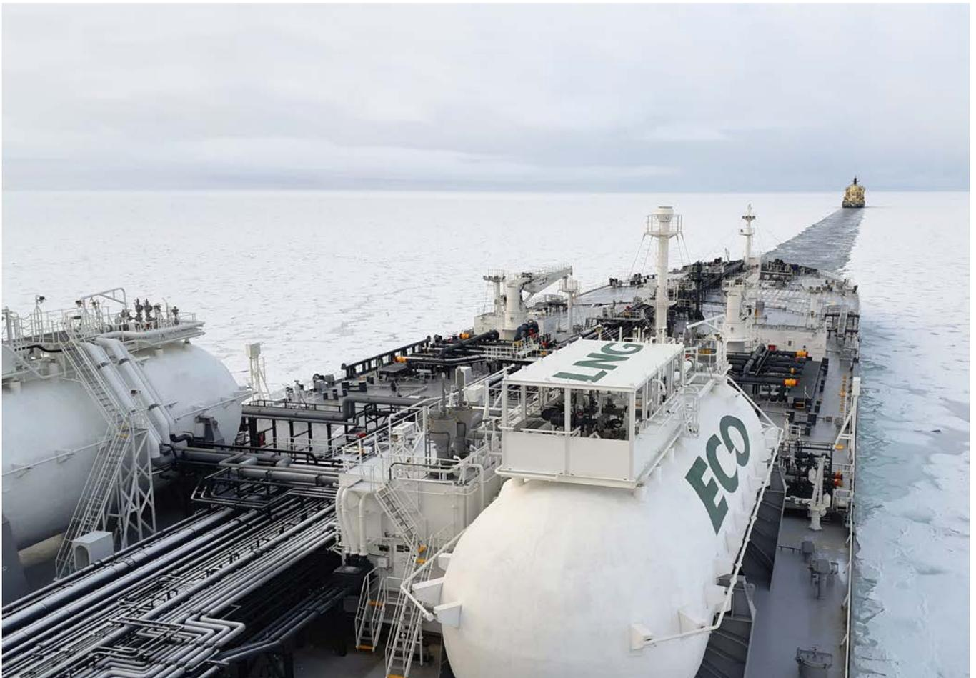
Преимущества работы на СПГ наиболее наглядны в цифрах: снижение выбросов оксидов серы и сажи достигает 100 %, выбросы оксидов азота сокращаются на 76 %, а углекислого газа – на 27 % по сравнению с судовой энергетической установкой, работающей на стандартном тяжелом топливе.
